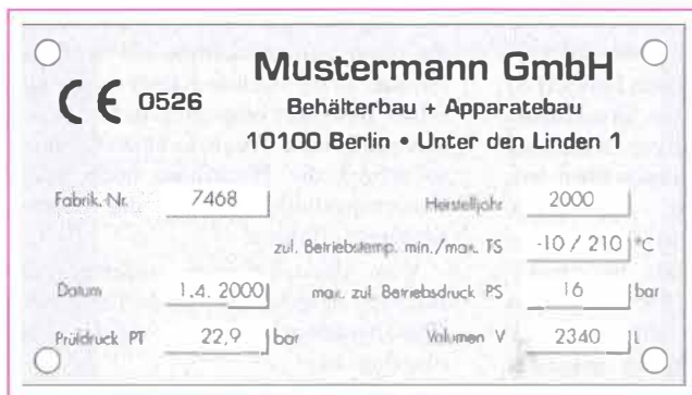
Abb. 3: Kennzeichnung eines Druckbehälters entsprechend der DGRL
