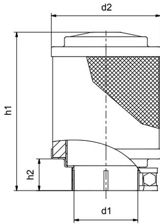
KFT® Nassluftfilter werden zur Filtration der Ansaugluft in staubarmer Umgebung eingesetzt, wie zum Beispiel bei Schiffsmotoren, Stromaggregaten und Kompressoren, die in geschlossenen Räumen betrieben werden.
